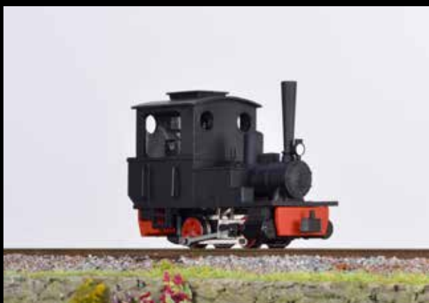
5031 - Koppel Dampflok mit geradem Schornstein - Koppel Steam Loco, straight Smokestack
